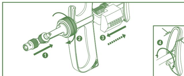
Connecter le corps, béquille enfoncée. Aligner la position de l'aimant sur le compteur, en maintenant la tige du piston immobile ④.
