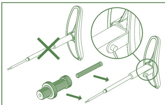
Assembler ressort et douille sur la béquille équipée de l'aimant.
